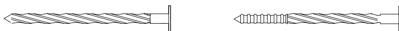
ステンレススクリュウ回転止め加工釘 A ステンレススクリュウ回転止め加工釘 B
